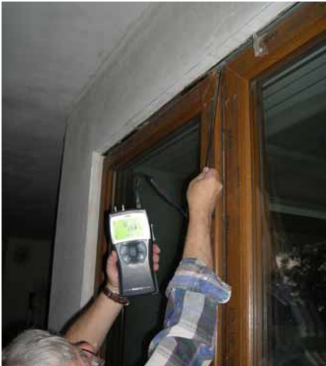
Rysunek 8.8 Nieszczelności spowodowane nieciągłością tynku wewnętrznego przy podejściach instalacji wodnej i kanalizacyjnej oraz nieszczelne drzwi przesuwne
