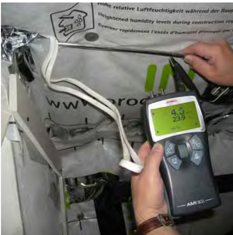
Rysunek 8.9 Nieszczelności spowodowane niedokładnym klejeniem folii paroszczelnych i nieuszczelnionymi przebiciami instalacji
