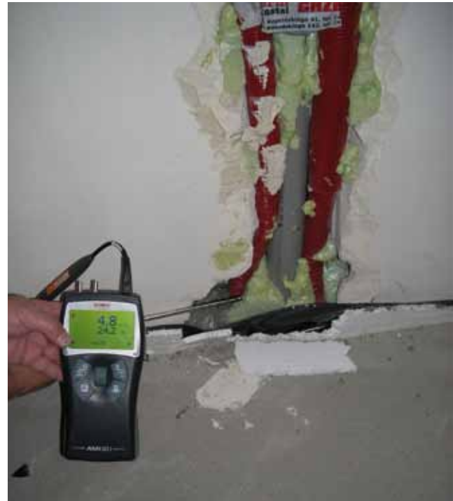
Rysunek 8.8 Nieszczelności spowodowane nieciągłością tynku wewnętrznego przy podejściach instalacji wodnej i kanalizacyjnej oraz nieszczelne drzwi przesuwne
