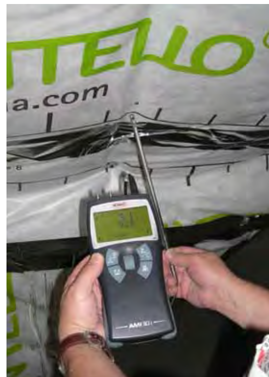
Rysunek 8.9 Nieszczelności spowodowane niedokładnym klejeniem folii paroszczelnych i nieuszczelnionymi przebiciami instalacji
